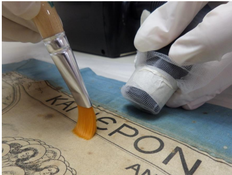
Εικόνα 24. Μηχανικός καθαρισμός επικαθίσεων με Museum vac και πινέλο (φωτογραφικό αρχείο φοιτητών).
