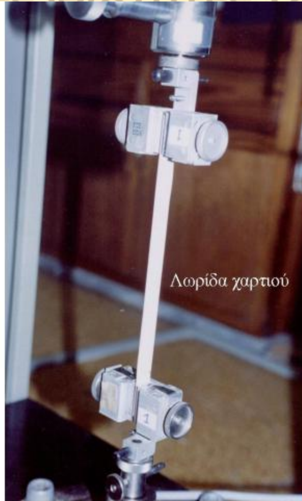
Εικόνα 1.29 Μέτρηση της εφελκυστικής αντοχής. Το δείγμα (λωρίδα χαρτιού) στερεώνεται από τα δύο άκρα του με δύο σφιγκτήρες, οι οποίοι απομακρύνονται ο ένας από τον άλλον με σταθερή ταχύτητα, έως ότου η λωρίδα χαρτιού κοπεί. Τότε το όργανο καταγράφει τη δύναμη με την οποία κόπηκε το δείγμα καθώς και την επιμήκυνσή του τη στιγμή της θραύσης.
