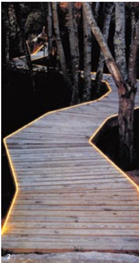
Εικ. 2. Εφαρμογή συστήματος οπτικών ινών γραμμικού φωτισμού σε εξωτερικό χώρο. (Πηγή: Ilti Luce)
