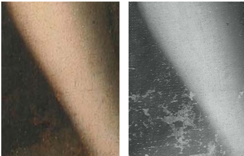
Εικόνες 3α και 3β: Λεπτομέρεια από το πόδι της Αφροδίτης – ορατή εικόνα και εικόνα της ανάκλασης της υπέρυθρης ακτινοβολίας μήκους κύματος 950-1150 nm.
