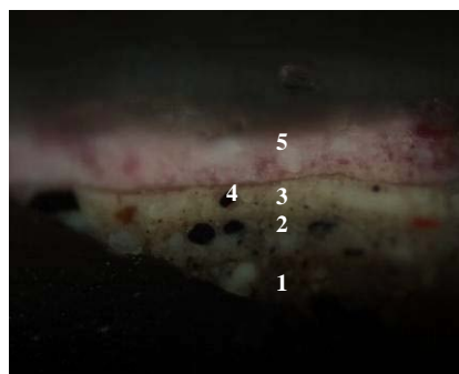
Εικόνα 8: Παρατήρηση στο ορατό στρωματογραφικής τομής από την εσάρπα της Αφροδίτης, μεγέθυνση 500X. Γίνεται διακριτό το πρώτο στρώμα προετοιμασίας (No.1), το δεύτερο στρώμα προετοιμασίας (No.2) το πρώτο (αυθεντικό) χρωματικό στρώμα (No. 3), λεπτό οργανικό στρώμα (No. 4) και δεύτερο (μεταγενέστερο) χρωματικό στρώμα (No.5)
