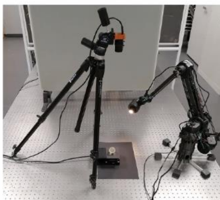
Εικόνα 5.6 Βασική διάταξη για ψηφιακή απεικόνιση RTI. Από το Workshop «Scientific Imaging of the Dead Sea Scrolls», “Imaging Activities at the Colourlab and Their Cultural Heritage Applications”, Jon Y. Hardeberg, Sony George, Hilda Deborah, NTNU–Norwegian University of Science and Technology.
