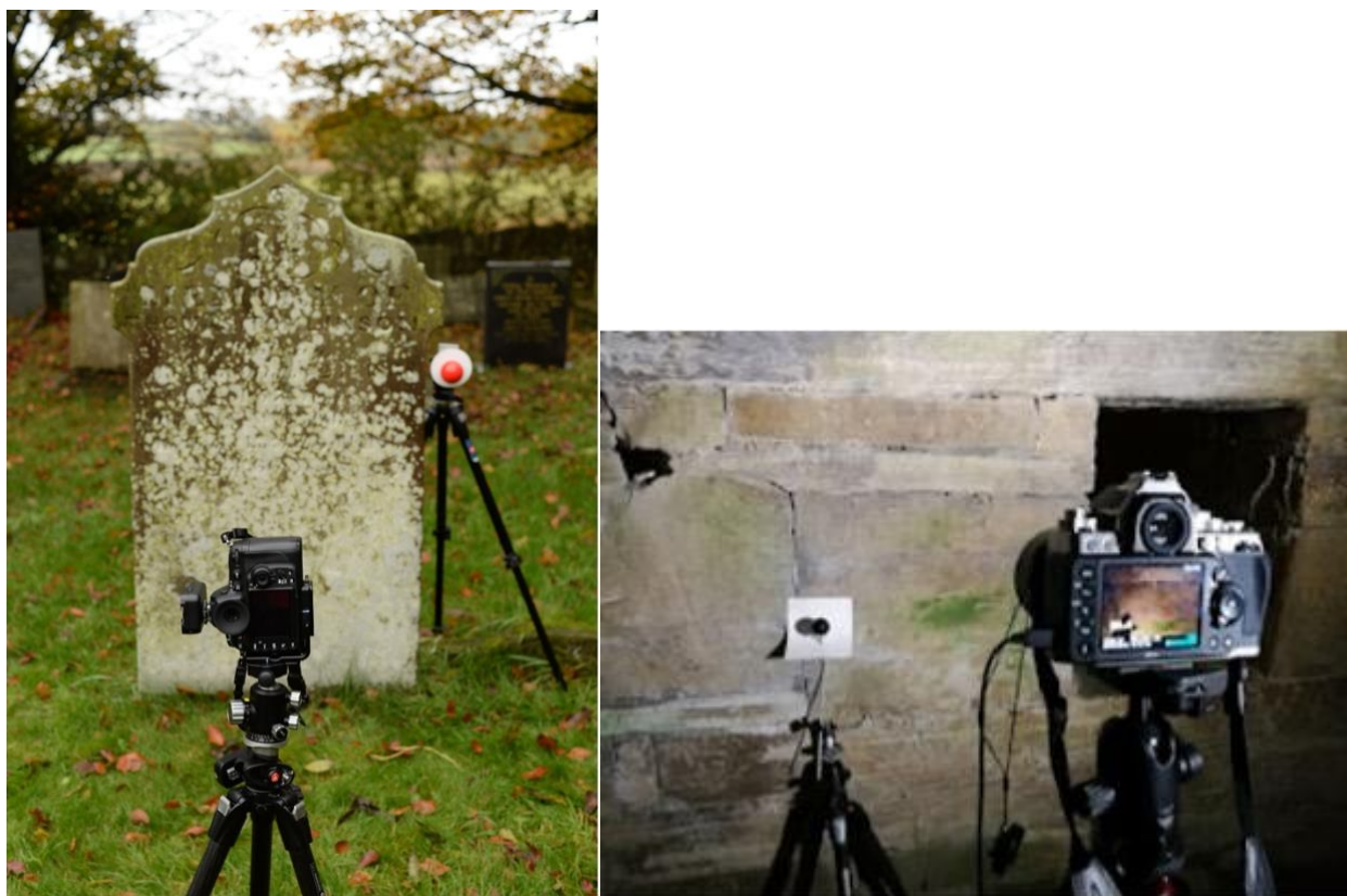
Εικόνα 5.5 Βασική διάταξη για ψηφιακή απεικόνιση H-RTI με ορατές τις αντανακλαστικές σφαίρες. Από το Smith et al. 2018 (άδεια Creative Commons BY 3.0 ).
