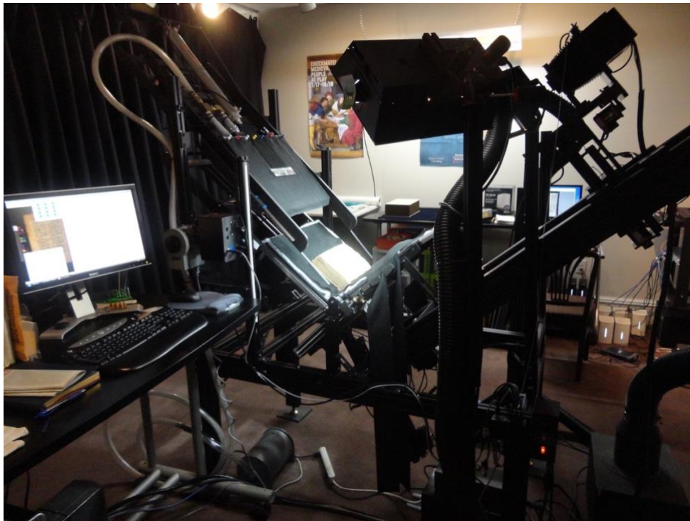
Εικόνα 2.2 Ο εξοπλισμός που απαιτείται για την ψηφιοποίηση μπορεί να είναι περίπλοκος και να αποτελείται από μία συσκευή και ένα τερματικό έως και συνδυασμό συσκευών λήψης εικόνας, φωτισμού, τερματικών και πολλών βοηθητικών εξαρτημάτων, ενώ συχνά οι βάσεις για την τοποθέτηση των αντικειμένων είναι αυτοσχέδιες ή προσαρμοσμένες στις ανάγκες του υλικού. Στη φωτογραφία σύστημα ψηφιοποίησης χειρογράφων που χρησιμοποίησε το Walters Art Museum Illuminated Manuscripts (Public Domain).
