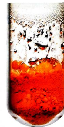
Σχήμα 1.10 ▲ Πυρωμένο οξείδιο του υδραργύρου(II). Όταν θερμαίνουμε οξείδιο του υδραργύρου(II), αυτό διασπάται σε υδράργυρο και αέριο οξυγόνο.
