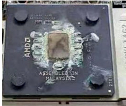
Εικόνα 2.1: Κατεστραμμένη Κ.Μ.Ε., λόγω υπερθέρμανσης
