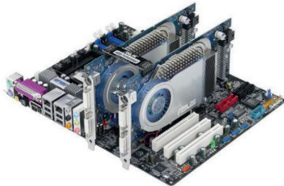
Εικόνα 1.3: Εγκατάσταση διπλών καρτών γραφικών τεχνολογίας SLI
