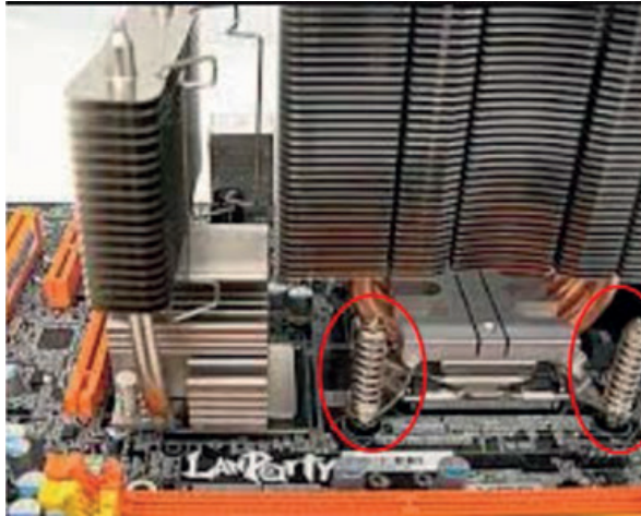
Εικόνα 2.3: Ψύκτρα με μηχανισμό στήριξης
