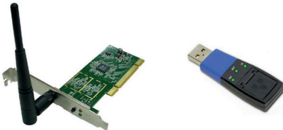
Εικόνα 9.3: Δύο μορφές καρτών Δικτύων: Κάρτα επέκτασης PCI (αριστερά) και USB Stick (δεξιά)
