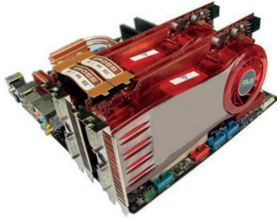
Εικόνα 1.2: Εγκατάσταση διπλών καρτών γραφικών τεχνολογίας Crossfire
