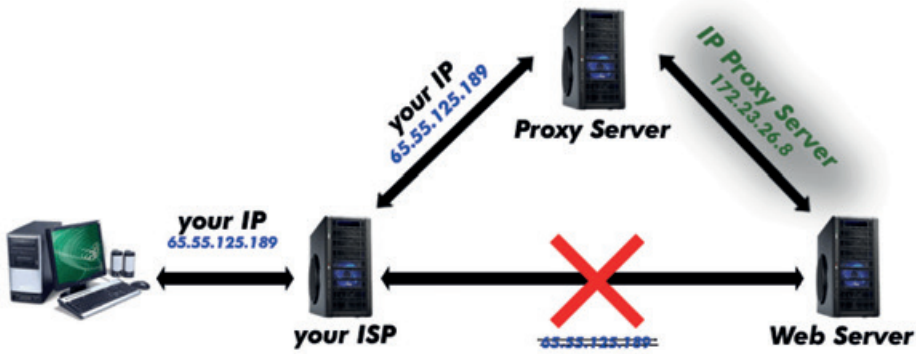
Εικόνα 8.19: Λειτουργία ανώνυμου διακομιστή μεσολάβησης
