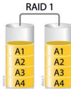
Εικόνα 3.2. Συστοιχία RAID 1 (mirroring).
