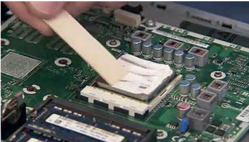
Εικόνα 2.7: Εφαρμογή θερμοαγώγιμης πάστας
