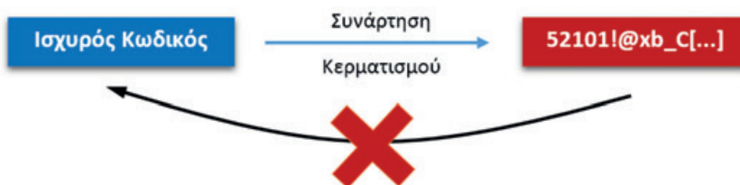
Εικόνα 8.7: Λειτουργία συνάρτησης κερματισμού
