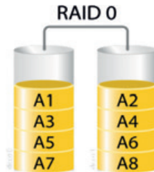
Εικόνα 3.1. Συστοιχία RAID 0 (striping).
