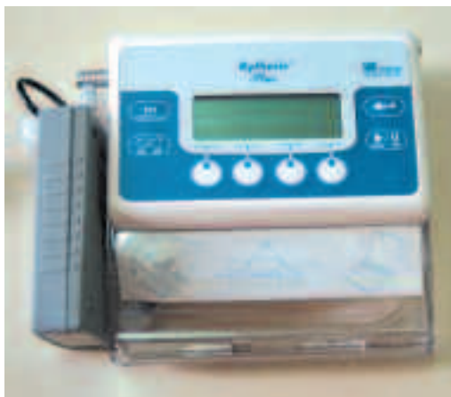
Περισταλτικές αντλίες με μικρομετρή. Το φάρμακο περιέχεται σε σακουλάκι που καλύπτεται από το διαφανές τμήμα της αντλίας
