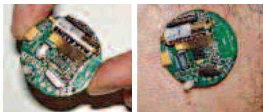
Εικόνες του εξαιρετικά μικρού καρδιογράφου/ αναλυτή σε δύο επίπεδα. Δεξιά φορεμένο στο στήθος
