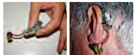
Εικόνες του εξαιρετικά μικρού σφυγμοζήμετρου σε δύο επίπεδα PCB, τοποθετημένου πίσω από το αυτί (δεξιά)
