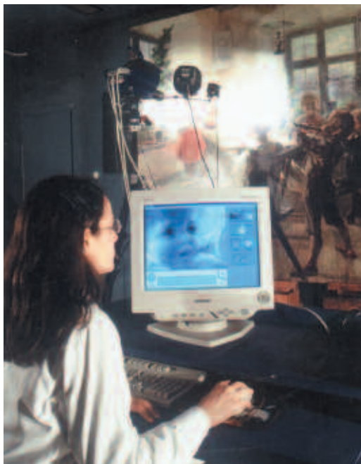
Το σύστημα πολυφασματικής απεικόνισης (Mysis) το οποίο παρέχει δυνατότητα απεικόνισης της ανάκλασης ή και του φθορισμού στην υπερύψη, στην ορατή και υπέρυθη περιοχή ( έως το 1550 nm). Επιπέυχθη η προσέγγιση του έργου πέρα από το χρωματικό στρώμα και να μελετήσουμε αθέατες πτυχές του, όπως είναι το σχέδιο
