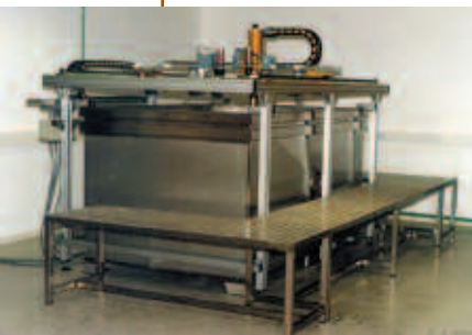
Πειραματική δεξαμενή ακουστικών μετρήσεων
