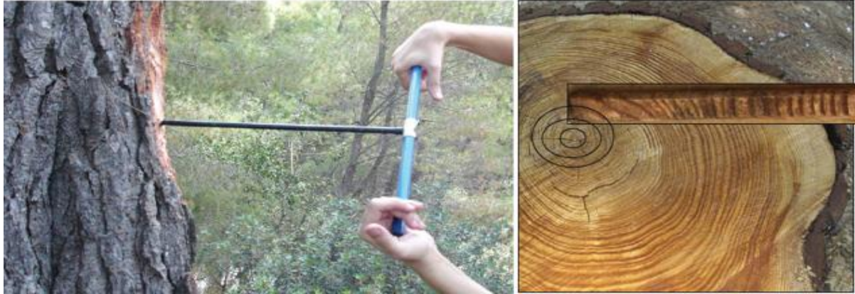
Τρόπος εξαγωγής δείγματος με τρυπάνι Pressler.
