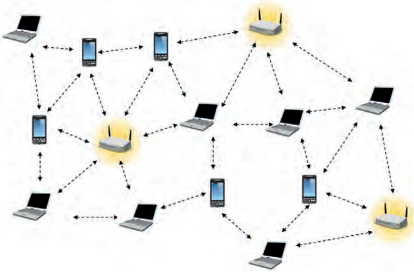
Σχήμα 2.5.1.α: Μετάδοση δεδομένων με χρήση τοπολογίας ad-hoc
