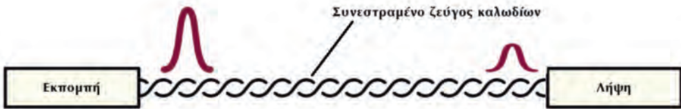
Εικόνα 2.4.1.θ: Εξασθένηση (Attenuation, Insertion Loss).
