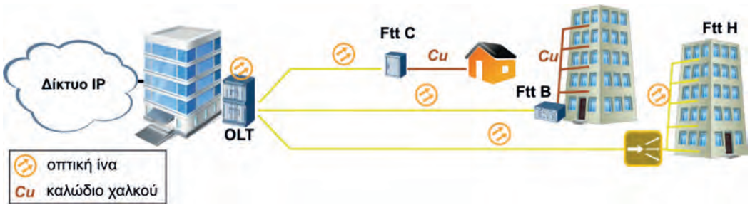
Εικόνα 5.2.β: Οπτική ίνα στην καμπίνα (Cabinet ή KV), στο κτίριο (Building) και στο σπίτι (Home)
