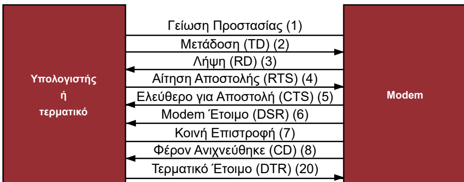
Σχήμα 5-4 Διασύνδεση υπολογιστή – modem με το πρότυπο RS232C. Οι αριθμοί των ακροδεκτών δίνονται στην παρένθεση
