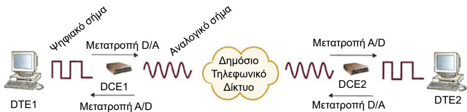
Σχήμα 5-2 Επικοινωνία τερματικών συσκευών DTEs με χρήση modems (DCEs) μέσω του Δημόσιου τηλεφωνικού δικτύου. Στο σχήμα, έχει σημειωθεί και η μετατροπή A/D ή D/A, που γίνεται στο σήμα
