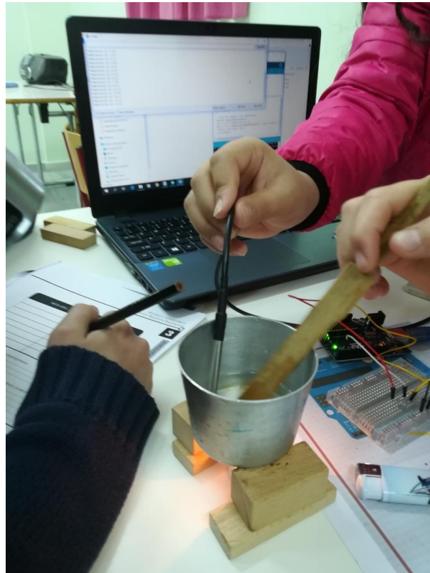
Εικόνα 5.6: Πείραμα 2ο μέτρηση θερμοκρασίας καθώς λιώνει ο πάγος
