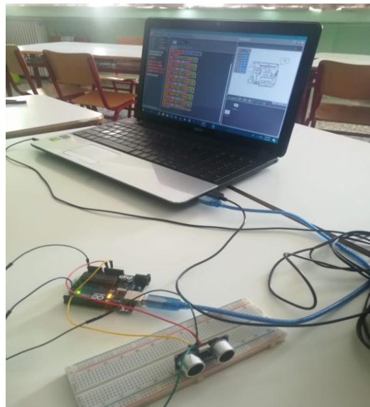
Εικόνα 5.3: Μέτρηση απόστασης με τον αισθητήρα υπερήχων
