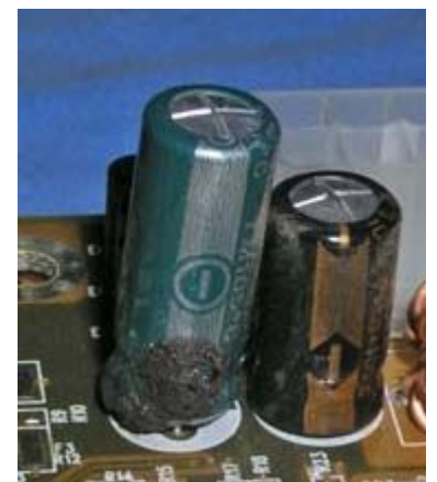
Εικόνα 263: Κατεστραμμένος πυκνωτής σε μητρική πλακέτα
