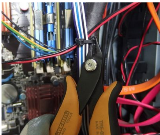
Εικόνα 23.Ελευθέρωση δεματικού (Cable Tie) καλωδίων
