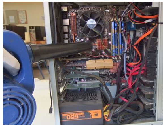
Εικόνα 68.Καθαρισμός με ηλεκτρικό φουσητήρα
