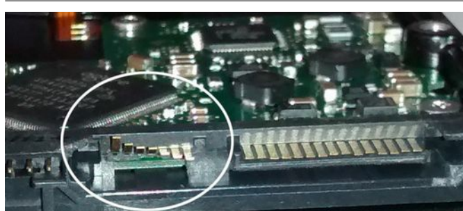
Εικόνα 265: Δίσκος SATA με σπασμένη υποδοχή καλωδίου δεδομένων
