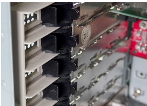
Εικόνα 34.Στερέωση καρτών επέκτασης χωρίς εργαλεία
