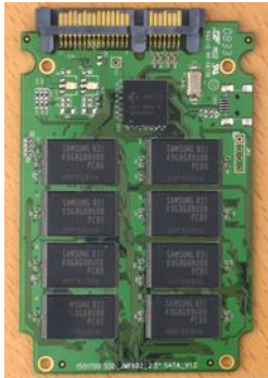
Εικόνα 144: Το εσωτερικό ενός δίσκου SSD με διασύνδεση SATA Πηγή: flickr.com
