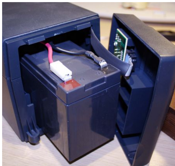
Εικόνα 252 Αλλαγή μπαταρίας UPS
