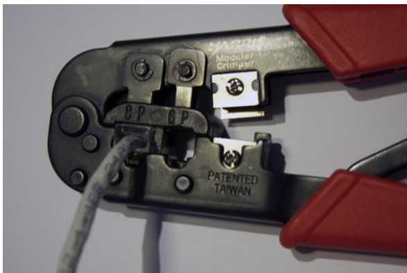
Εικόνα 10: Πρεσάρισμα φικ RJ45
