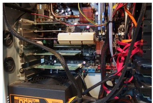
Εικόνα 53. Θήκη με σχεδίαση για τοποθέτηση του τροφοδοτικού στο κάτω μέρος
