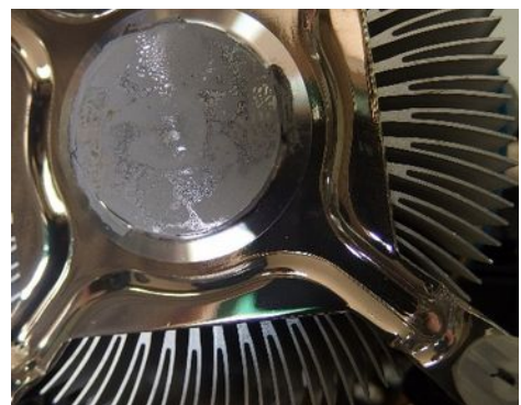
Εικόνα 65. Κατάλοιπα θερμοαγωγίμης κόλλας
