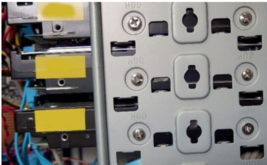
Εικόνα 31.Στήριξη μονάδων δίσκων στο πλαίσιο της θήκης
