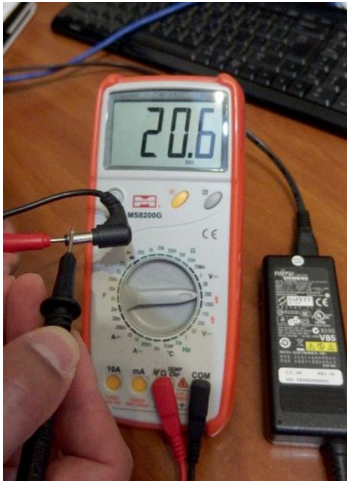
Εικόνα 196. Μέτρηση τροφοδοτικού με πολύμετρο
