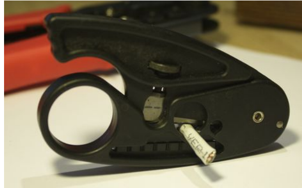
Εικόνα 5: Απογυμνωτής εξωτερικής μόνωσης καλωδίων UTP
