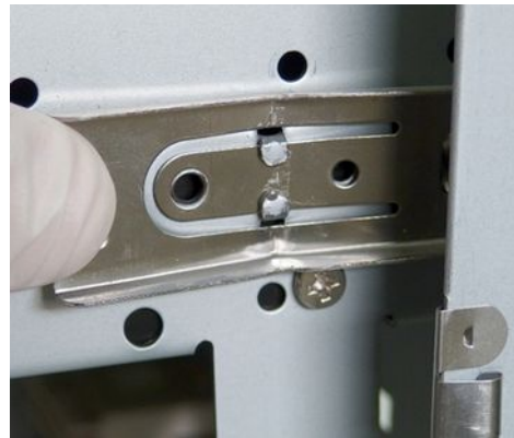
Εικόνα 33.Ελευθέρωση ελάσματος συγκράτησης
