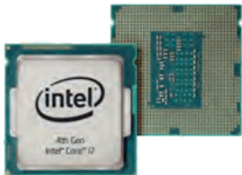
Εικόνα 1.6. Κεντρική Μονάδα Επεξεργασίας
