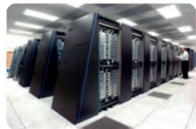
Εικόνα 1.2. Ο υπερυπολογιστής Blue Gene/P στο Argonne National Lab αποτελείται από περισσότερους από 250.000 επεξεργαστές.
