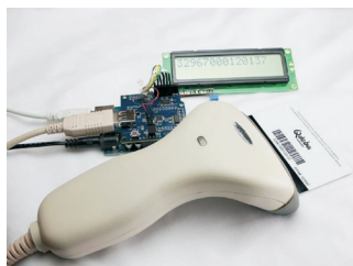
Εικόνα 3.9. Συσκευή γραμμωκώδικα με χρήση πλακέτας Arduino.
