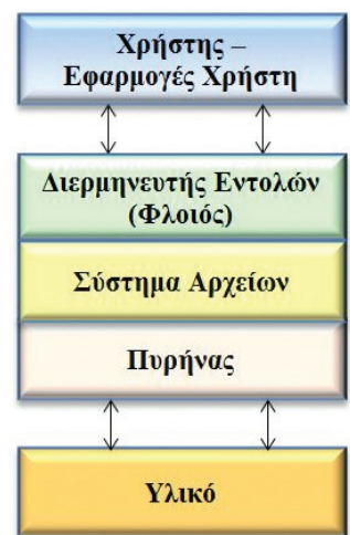
Εικόνα 3.1. Διαστρωμάτωση ενός Λ.Σ.
