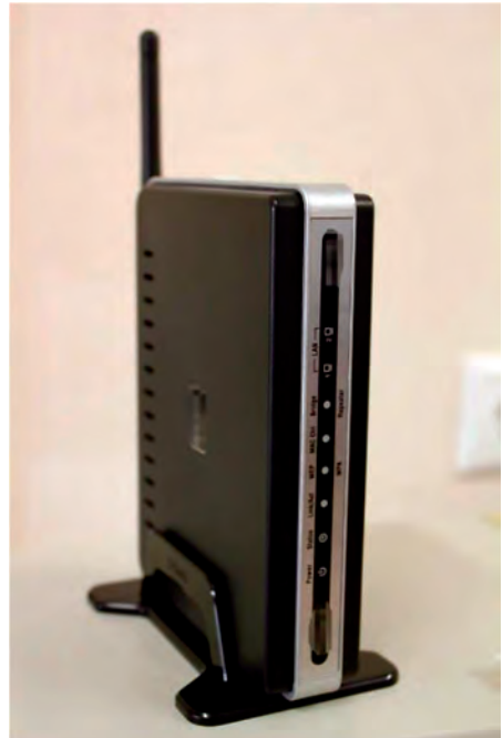
Εικόνα 154: Wireless Access Point
