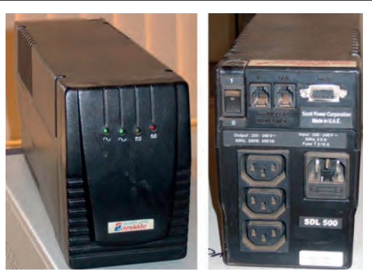
Εικόνα 249 Όψεις μονάδας UPS
