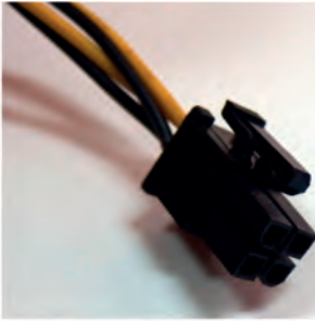
Εικόνα 39. Σύνδεσμος 4 ακίδων (12 Volt)
