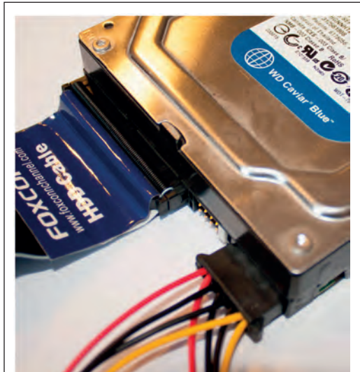
Εικόνα 146: Σύνδεση δίσκου με καλώδιο δεδομένων PATA και ρεύμα με σύνδεσμο τύπου Molex. Ενδιάμεσα διακρίνονται οι διακόπτες γέφυρας για τον ορισμό του δίσκου ως κύριου ή δευτερεύοντος
