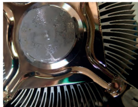
Εικόνα 65. Κατάλοιπα θερμοαγωγίμης κόλλας
