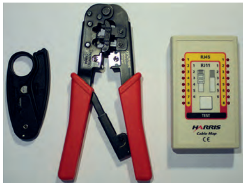
Εικόνα 4: Εργαλεία τερματισμού καλωδίου UTP
