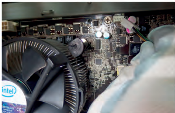
Εικόνα 57. Τοποθέτηση συνδέσμου ανεμιστήρα ΚΜΕ 4 καλωδίων (PWM), στην υποδοχή ανεμιστήρα ΚΜΕ (CPU_FAN) εργοστασιακού συστήματος ψύξης
