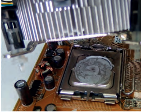
Εικόνα 63. Αφαίρεση συστήματος ψύξης
