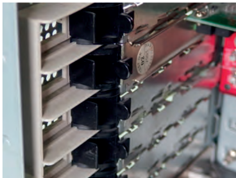
Εικόνα 34. Στερέωση καρτών επέκτασης χωρίς εργαλεία
