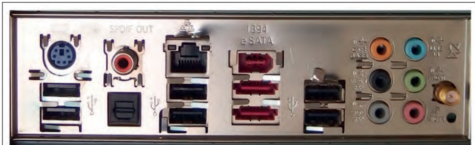
Εικόνα 89. Back I/O με I/O Shield από νεότερη μητρική πλακέτα.
