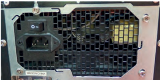
Εικόνα 24.Το πίσω μέρος ενός τροφοδοτικού ATX
