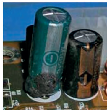
Εικόνα 263: Κατεστραμμένος πυκνωτής σε μητρική πλακέτα
