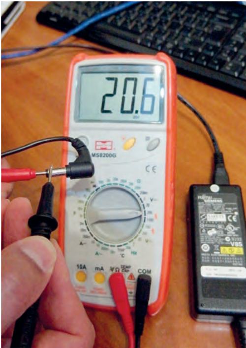
Εικόνα 196. Μέτρηση τροφοδοτικού με πολύμετρο
