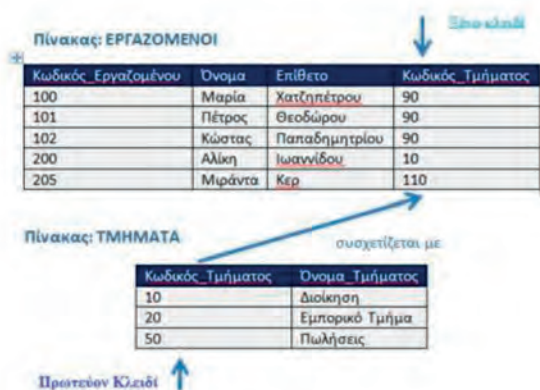
Σχήμα 3.5.4: Το ξένο κλειδί ενός πίνακα «συνδέεται» με το πρωτεύον κλειδί ενός άλλου πίνακα
